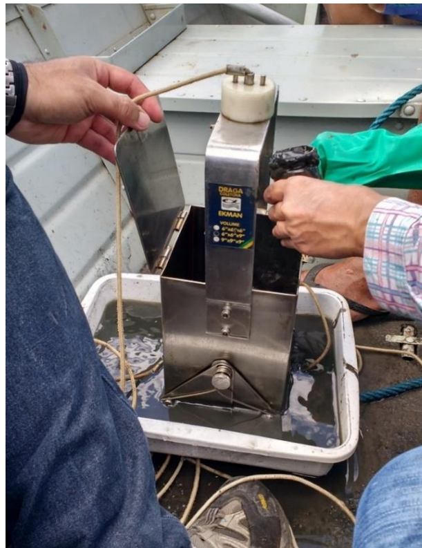
Figura 8 - Draga coletora Ekman (coleta das amostras de sedimento de fundo do reservatório Maranguapinho)
