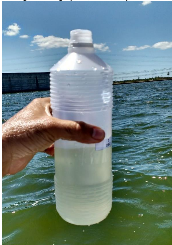
Figura 16 - Amostragem na Barragem Maranguapinho, com destaque a tonalidade verde escuro das amostras
